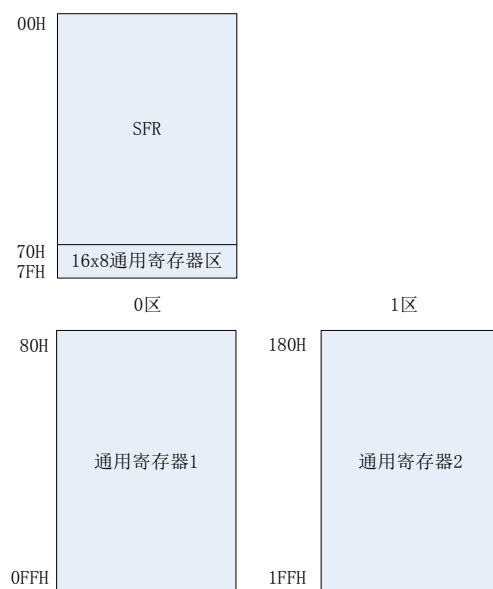
图 3-4：数据存储器地址映射图
