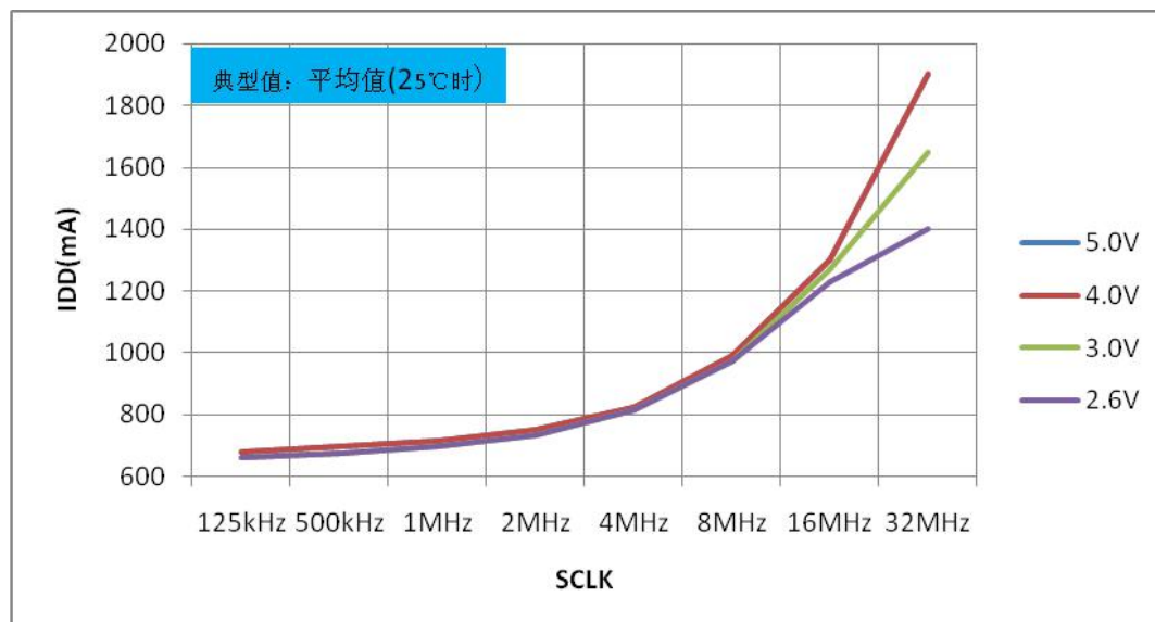
图19-1: 不同VDD 时典型IDD — SCLK 关系曲线图
