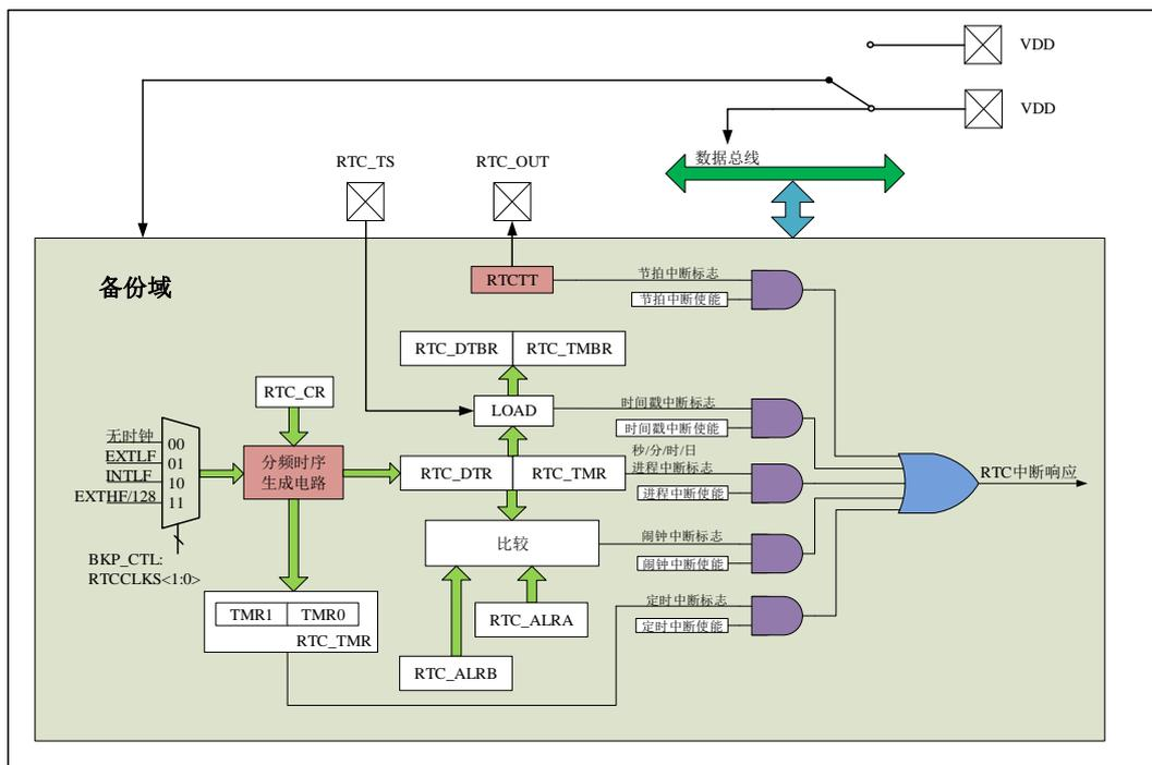
图 26-1 RTC 结构框图
