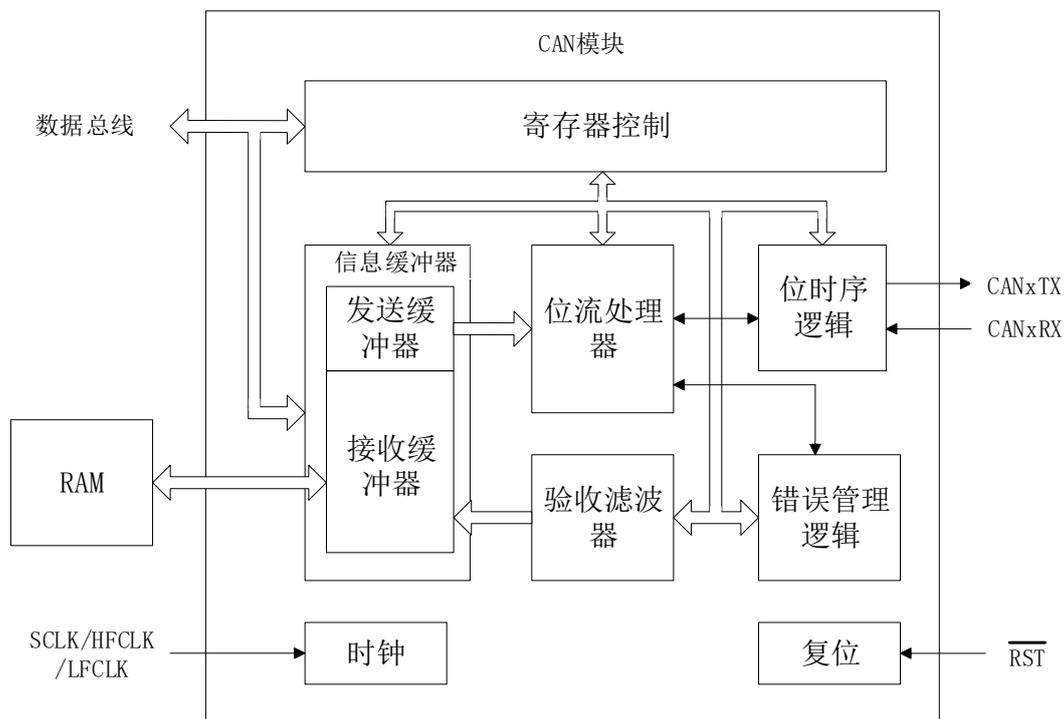
图 27-1 CAN 模块结构框图
