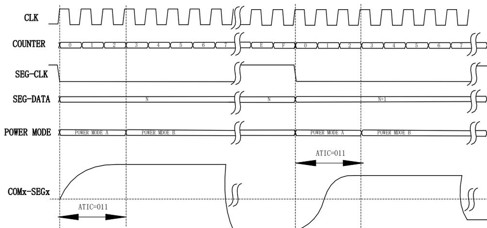
图 24-5 LCD 功耗模式自动切换例图 (Type-A waveform)
