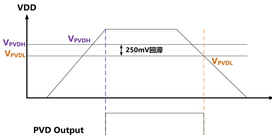
图 33-5 电压检测说明简图
