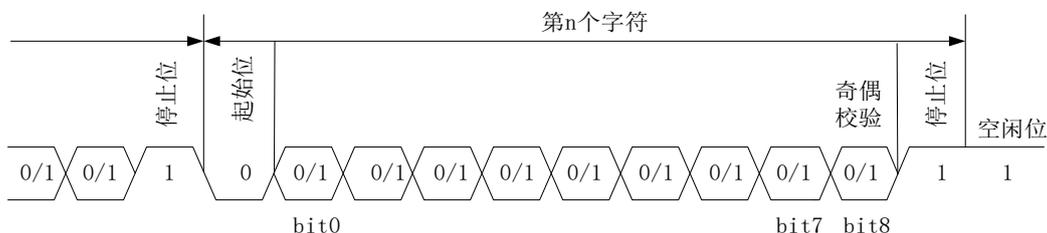
图 21-4 全双工异步通信数据结构图
