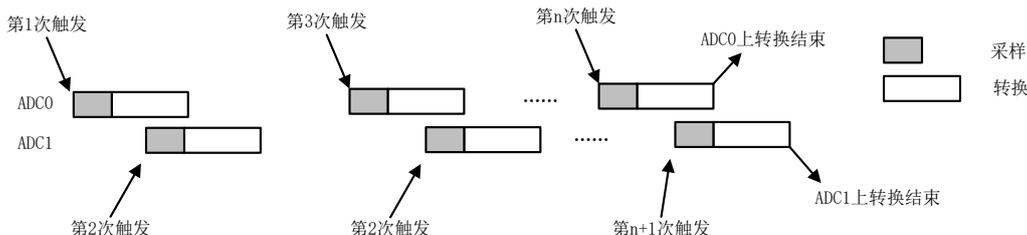
图 17-10 交替触发-有间隔交替模式
