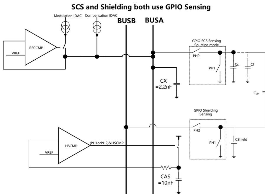
图 30-16 使用 CAS 和 HSCMP 驱动屏蔽电极
