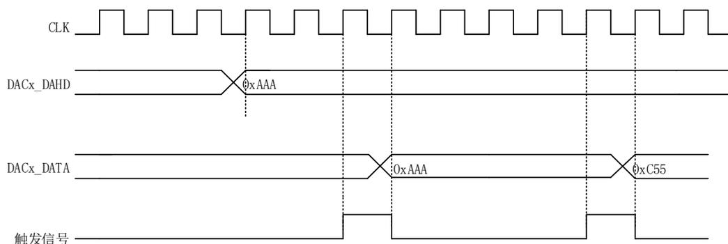
图 18-3 LFSR 产生波形的 DAC 转换
