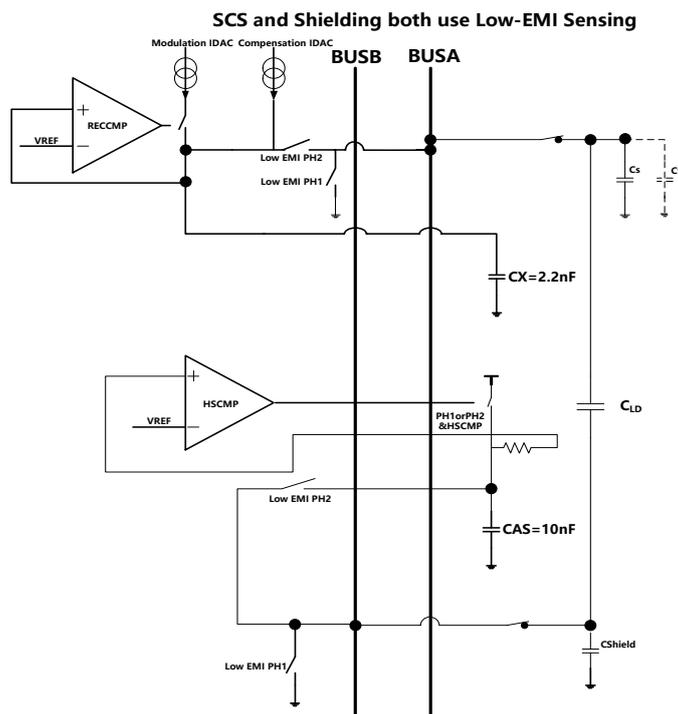
图 30-17 使用内部 Low-EMI 驱动屏蔽电极
