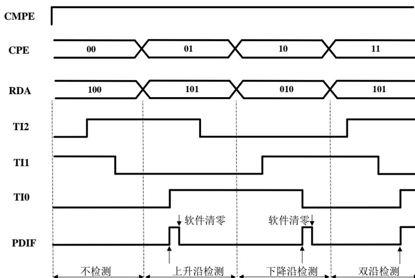
图 15-19 CMPE=1 位置检测时序图
