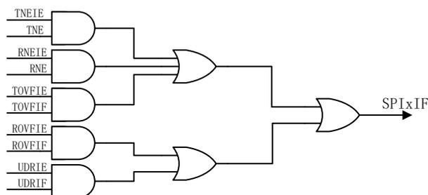
图 22-11 SPI 中断框图
