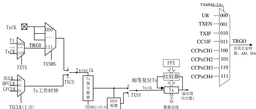
图 12-1 通用定时器结构框图<sup>1</sup>
