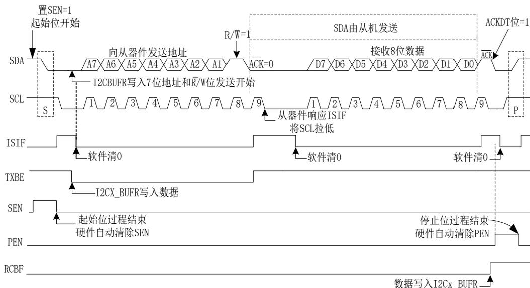
图 23-15 I2C 主模式接收数据时序图
