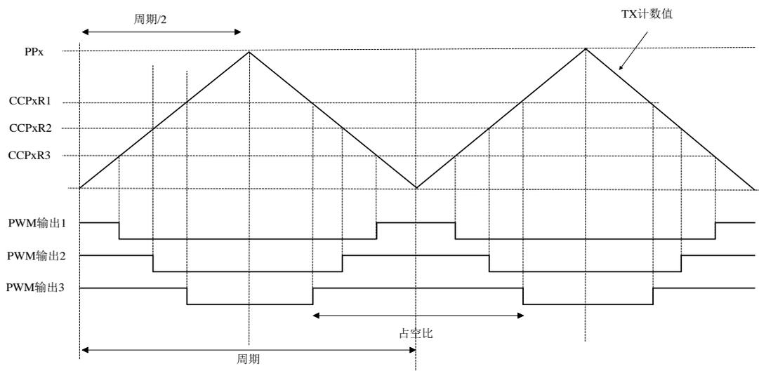
图 15-8 ECCP 中心对齐模式 PWM 输出
