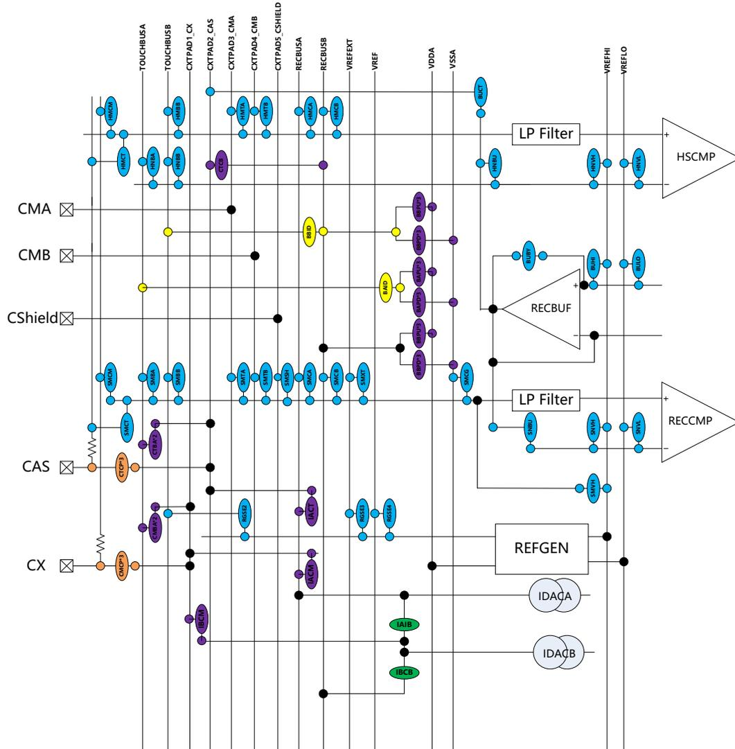
图 30-3 CTOUCH SWITCH 连接图
