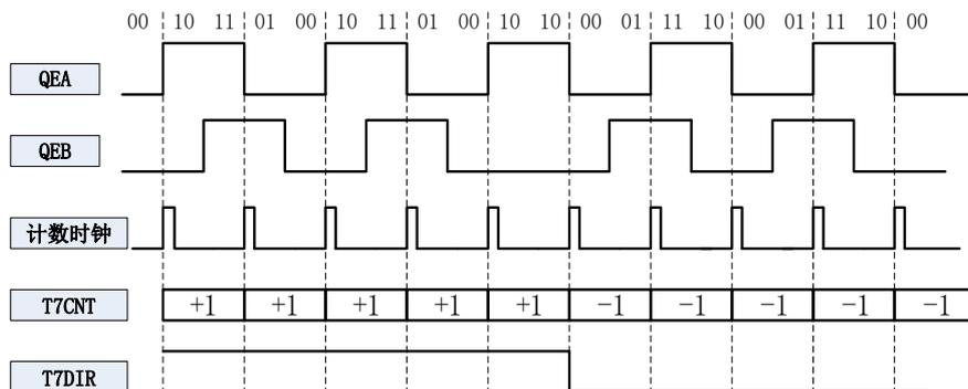
**图 16-6 x2 模式下正交编码信号**
