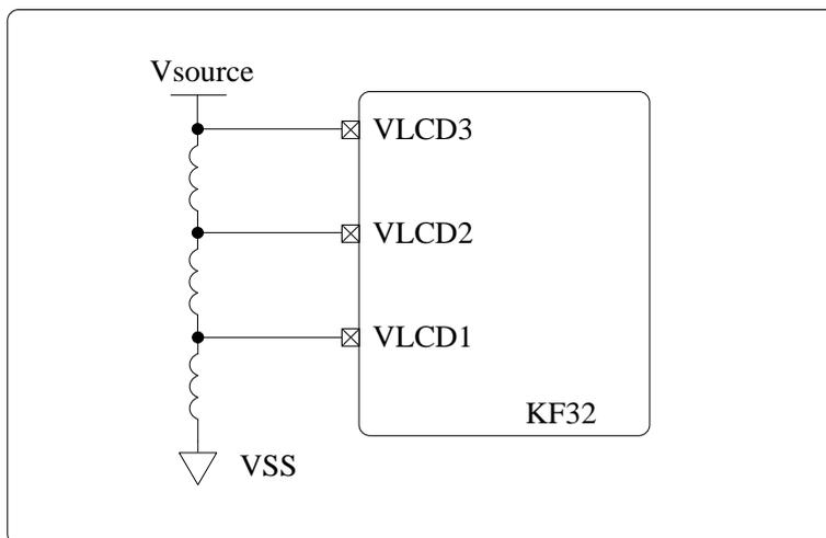
图 24-3 LCD 梯形 1/3 偏置电阻外接框图
