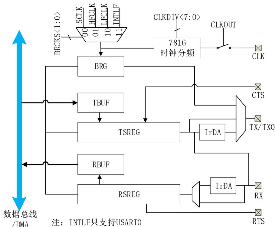
图 21-1 USART 结构框图
