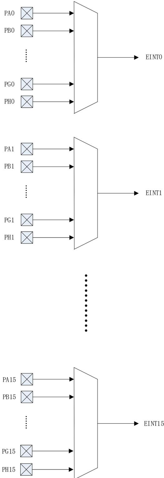
图 7-4 引脚外部中断线映射图
