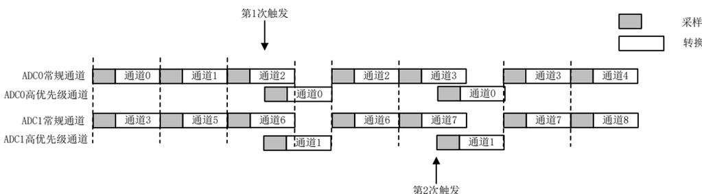
图 17-11 混合常规通道同步+高优先级通道同步模式
