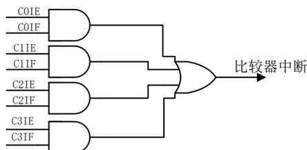
图 19-6 CMP 中断逻辑框图
