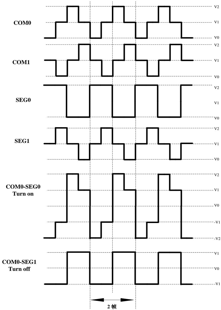
图 24-9 1/2 复用 1/2 偏置驱动下 B 型波形
