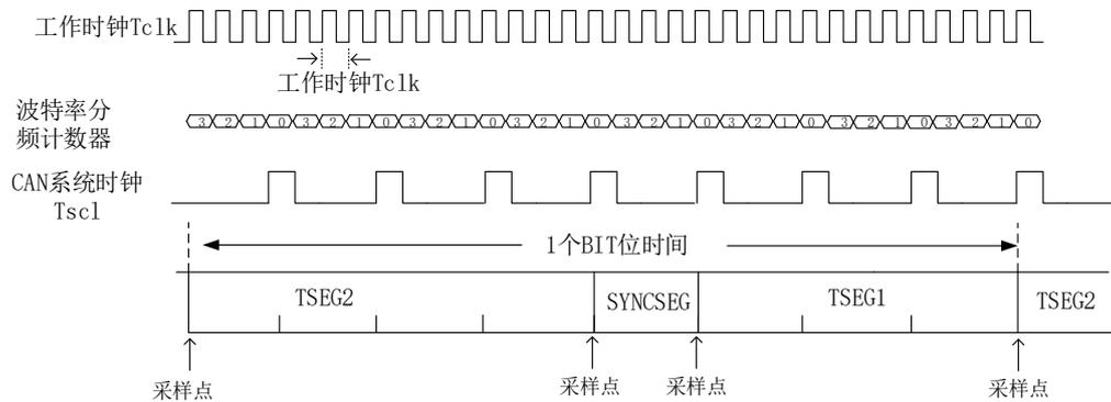
图 27-2 CAN 波特率原理图
