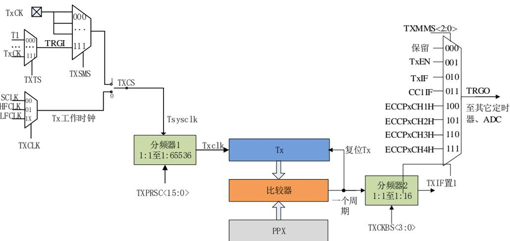
图 13-1 高级定时器结构框图
