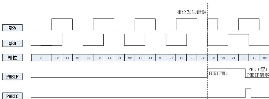
图 16-8 QEI 相位检测错误示意图
