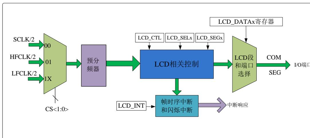
图 24-1 LCD 模块结构框图
