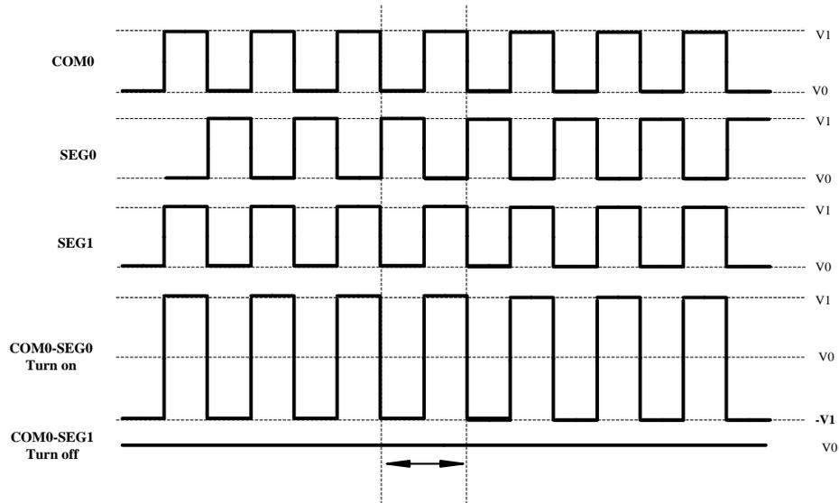
图 24-7 静态驱动下 A/B 型波形
