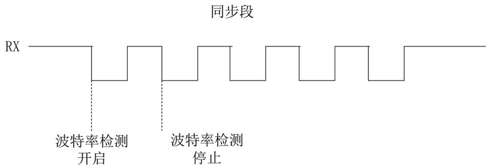
图 21-3 自动波特率检测示意图
