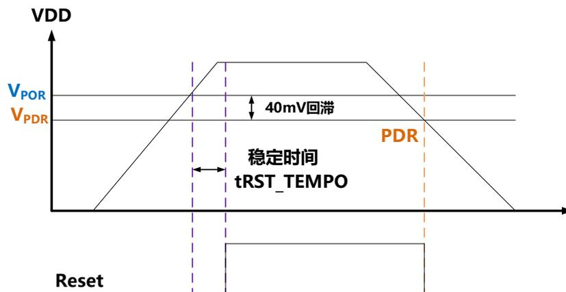
图 33-2 POR/PDR 电压说明简图
