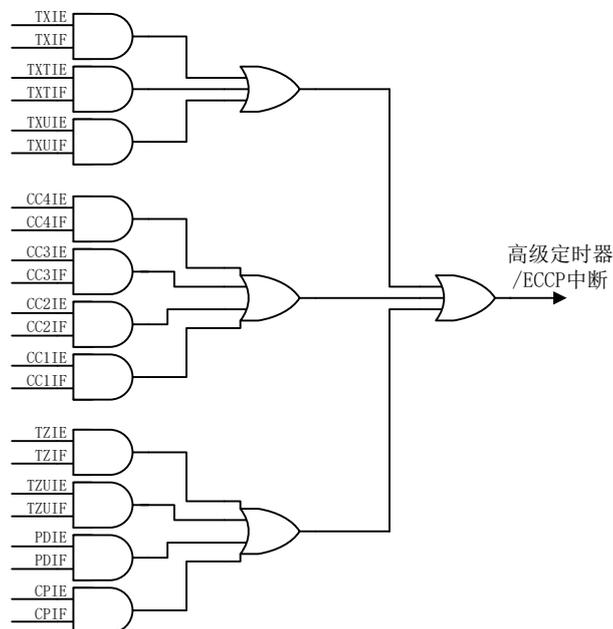
图 15-2 高级定时器/ECCP 中断框图
