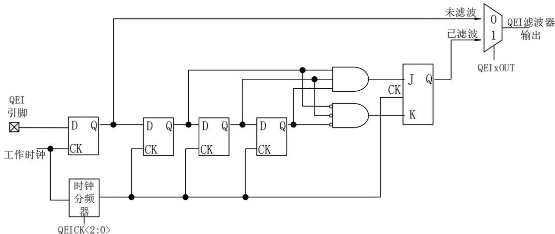
图 16-4 QEI 可编程噪声滤波器
