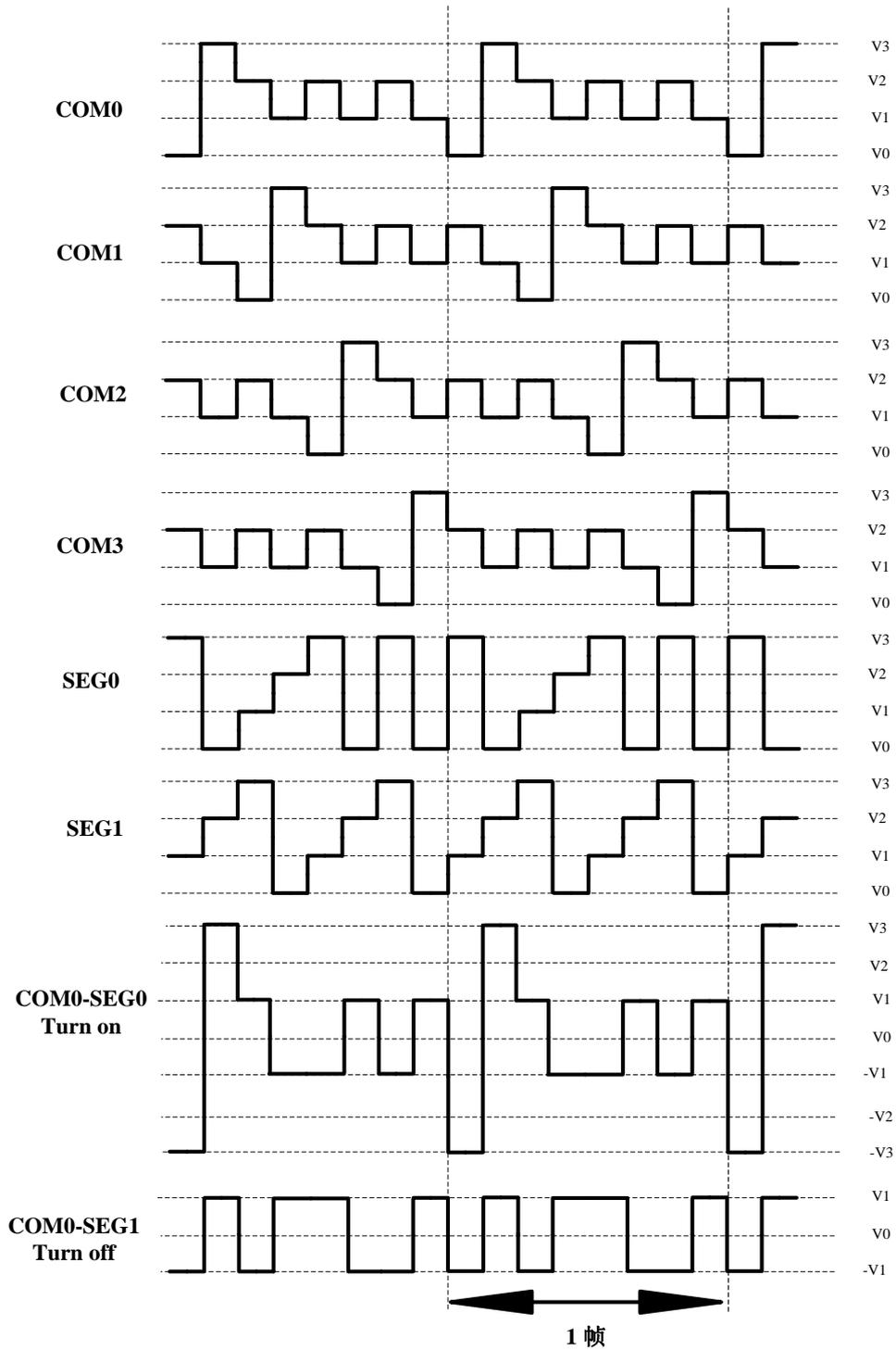
图 24-16 1/4 复用 1/3 偏置驱动下 A 型波形
