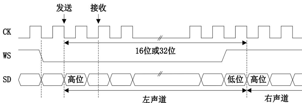
图 22-6 I2S 飞利浦协议波形(16/32 位全精度)
