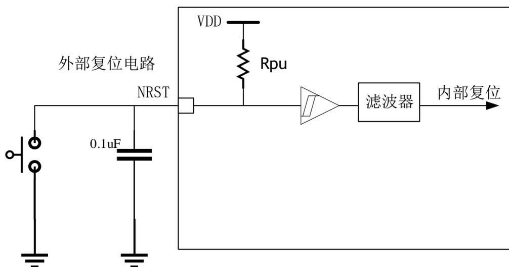
图 33-4 建议 NRST 复位电路
