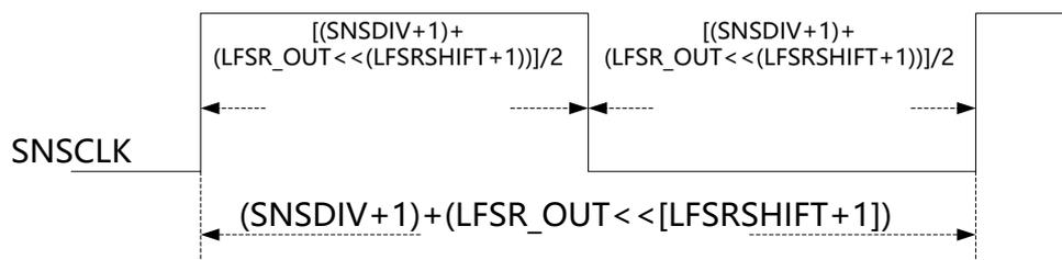
图 30-34 PWM 关闭并且扩频开启的情况下 SNSCLK 的产生
