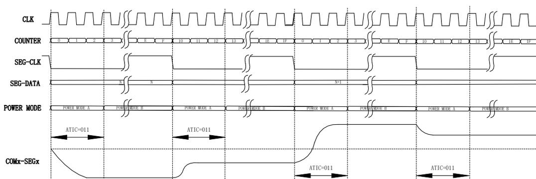
图 24-6 LCD 功耗模式自动切换例图 (Type-B waveform)
