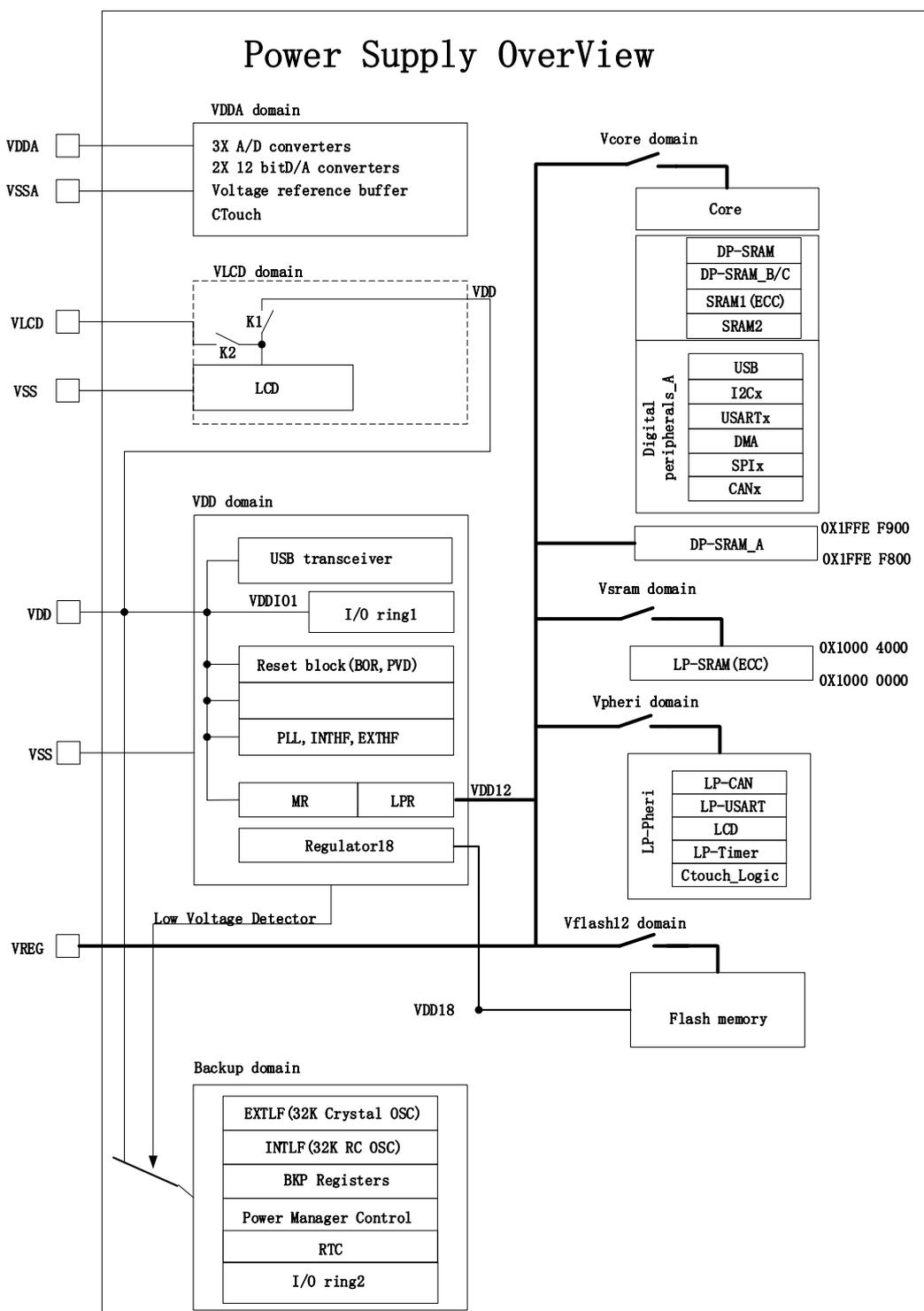
图 35-1 电源结构框图
