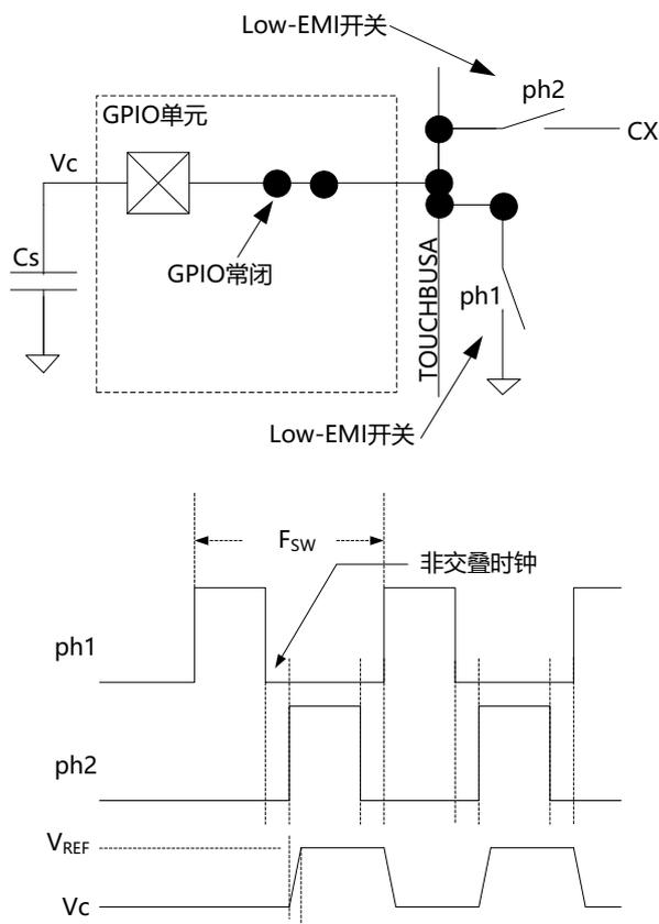
图 30-7 自电容感应-Low-EMI 开关
