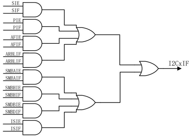
图 23-19 I2C 中断框图
