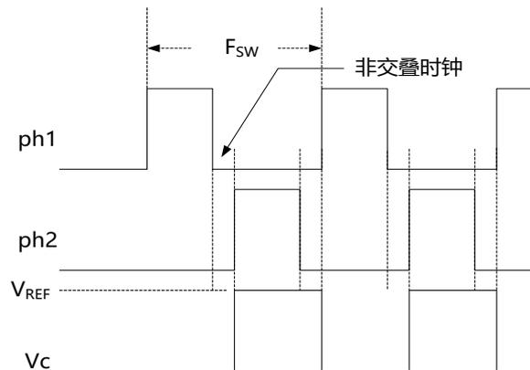
图 30-5 自电容感应时的 GPIO 时钟配置
