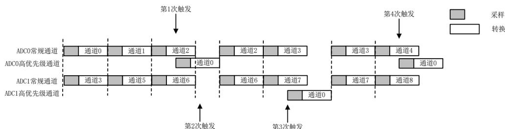
图 17-13 混合常规通道同步+交替触发模式 2
