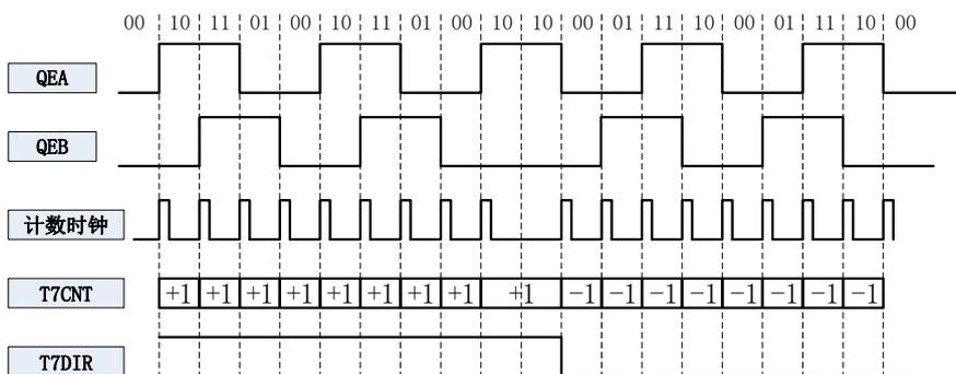
图 16-5 x4 模式下正交编码信号
