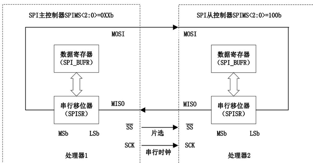
图 22-3 SPI 主从控制器连接 (SPIIOS=1)
