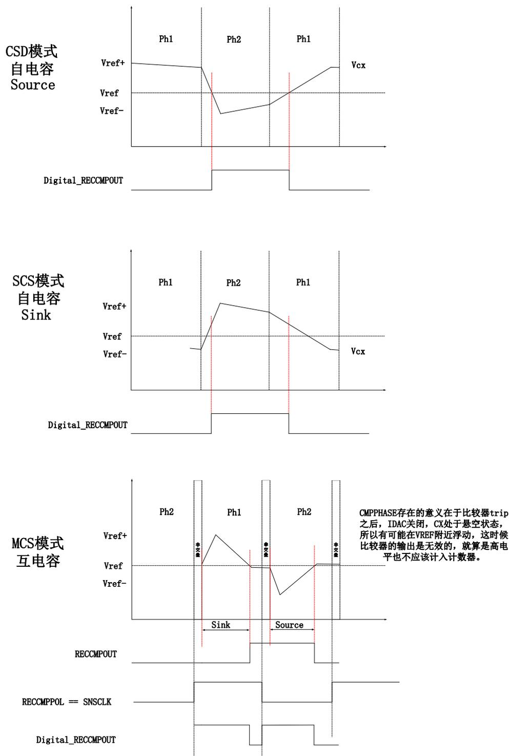
图 30-22 SCS 模式的 Cx 波形
