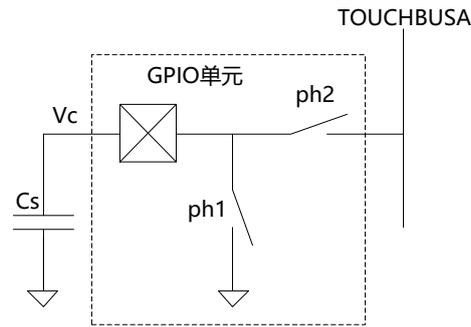
图 30-4 GPIO 开关形式
