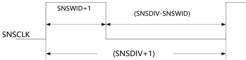
图 30-33 PWM 功能开启，扩频功能关闭时 SNSCLK 的发生机制
