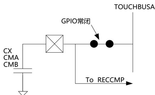
图 30-12 GPIO 连接外部电容的配置
