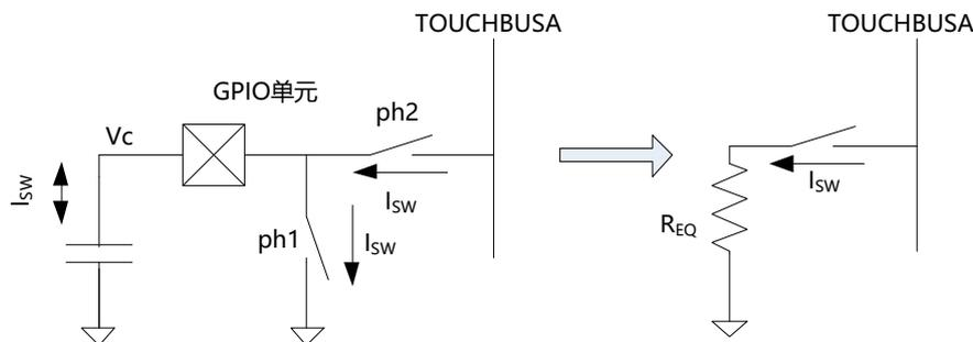
图 30-6 感应电极从 TOUCHBUS 抽取电流
