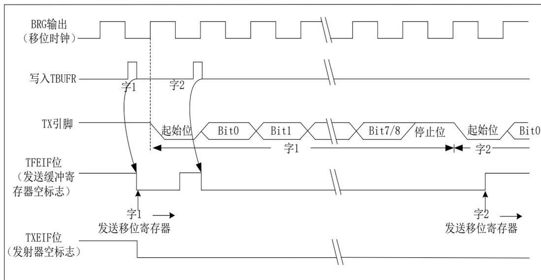
图 21-7 全双工异步发送（一字符接一字符）
