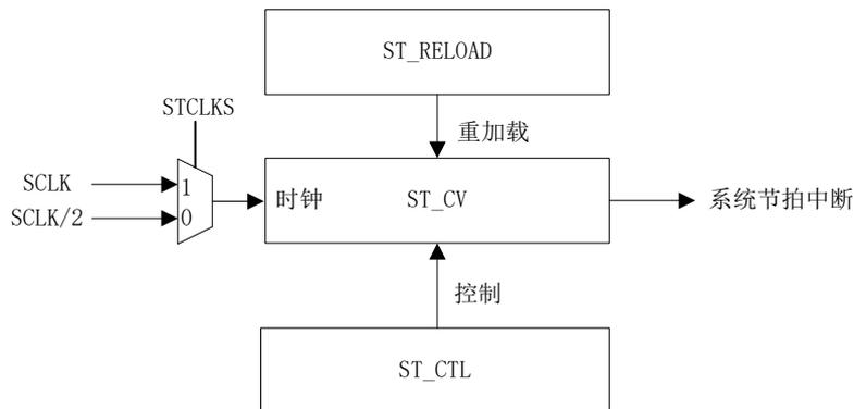
图 10-1 节拍定时器结构框图
