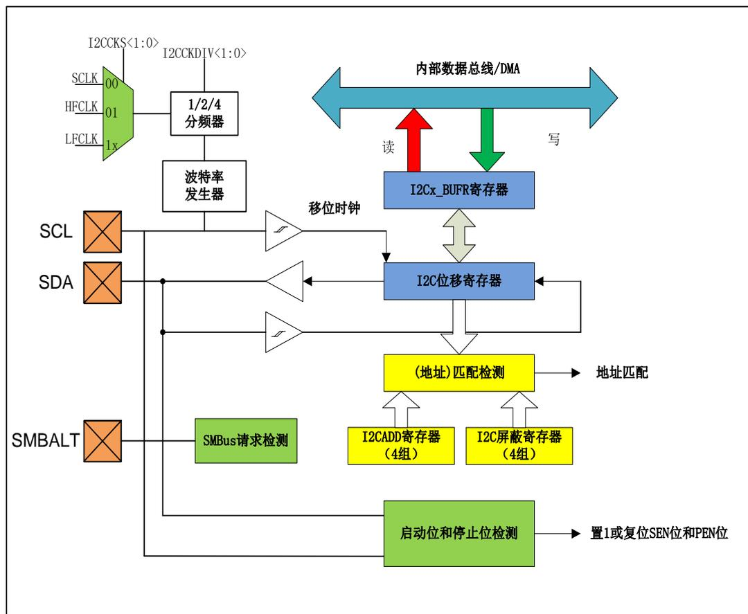
图 23-1 I2C 模块结构框图
