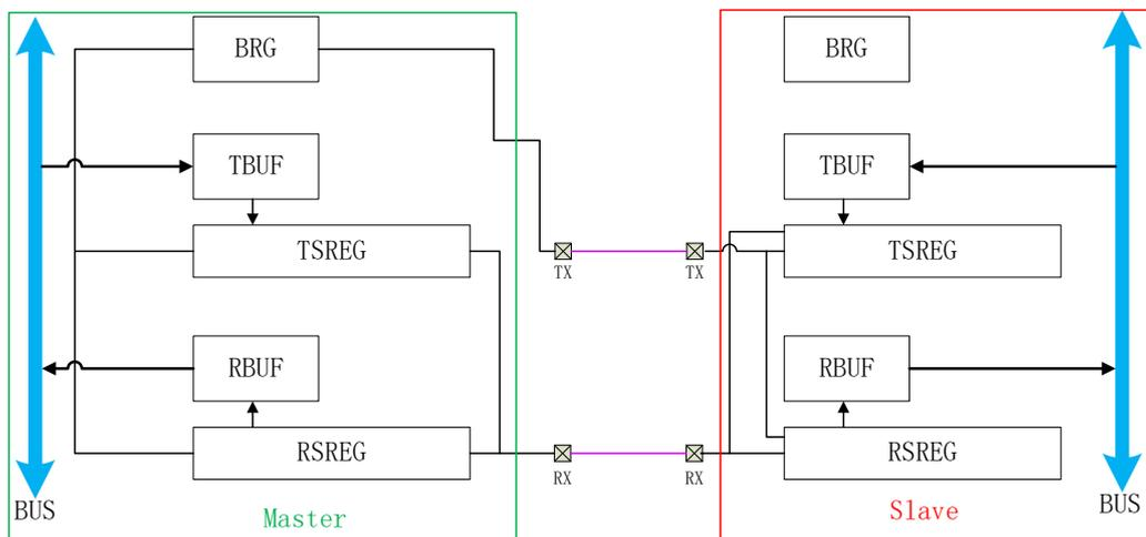
图 21-8 USART 半双工异步连接框图
