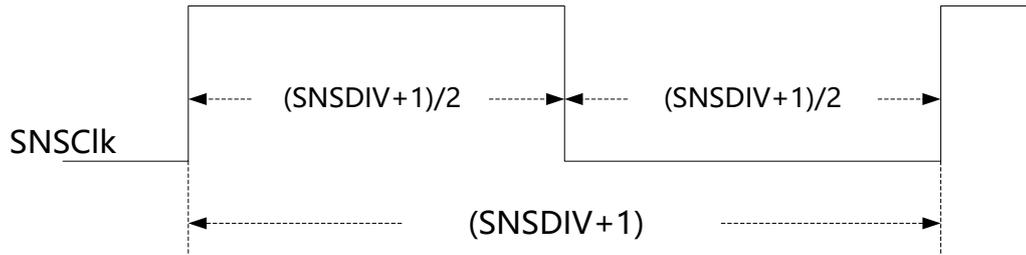
图 30-32 PWM 和扩频关闭时 SNSCLK 的波形
