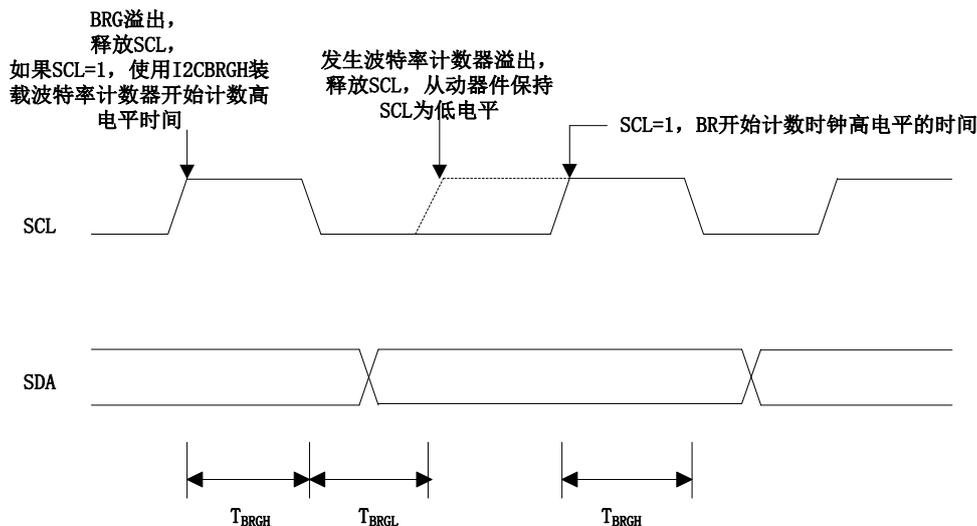
图 23-17 主控发送模式下的时钟仲裁时序
