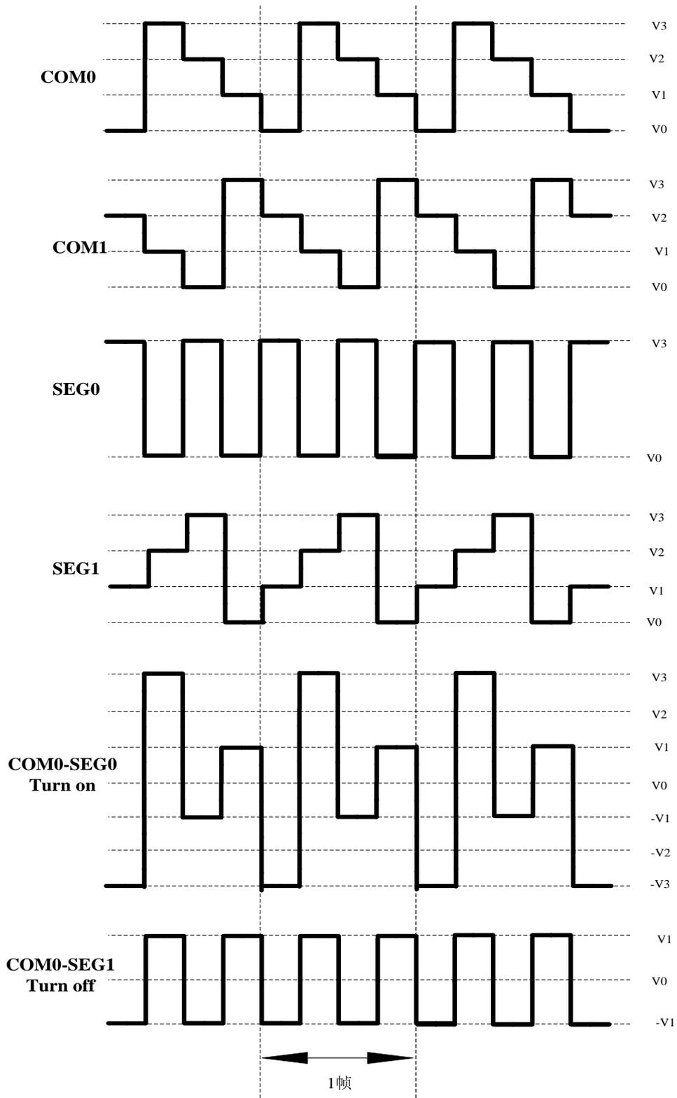
图 24-10 1/2 复用 1/3 偏置驱动下 A 型波形
